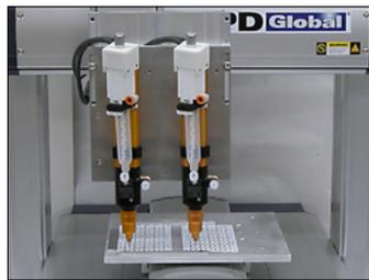
Island系列的工作平台上可装置一个简单型设有多个夹具固定螺丝孔的平台板块供客户自制的夹治具使用。也可选用可调式平台板块。为加强基板的固定或在点胶过程中确保基板平整，工作平台也可加设真空吸附基板功能。若点胶应用需要加热基板，工作平台也可装设加热器。无论哪种方式，Island系列系统可以适用于非常广泛的产品及点胶应用。
