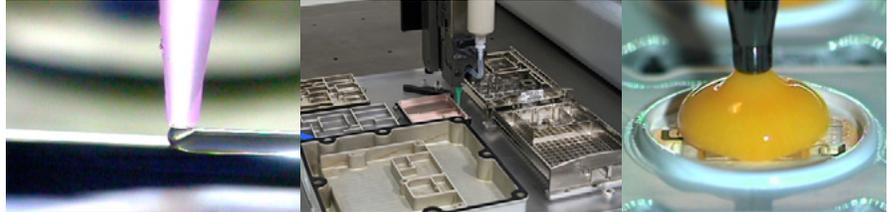
点，线，弧，圆，矩阵式排列等模块都已内建，让编程更容易。点胶模组中的每一区段都可以调整点胶参数，包括速度，时间，点胶高度等等，来达到最完善的点胶结果。不用一个小时你就可以完成机台安装，编程及正式开始点胶作业。一旦程序设好，它们保存到系统的内部存储器，并可以很容易地从触摸屏选择，可以贮存高达99个程序。
